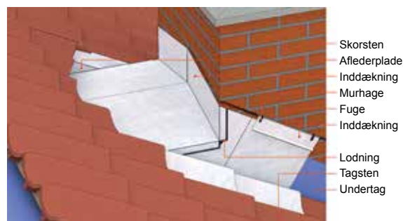
Figur 8. Skorsten, svineryg med sideværts hældning mindst 1:5 (12°).
