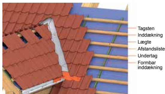
Figur 5. Kvist, overgang ved kip og tagfod.
