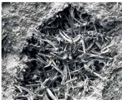
Udfældning af saltkrystaller i en luftpore i renoveringspuds.
