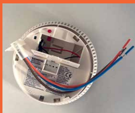
Figur 1. Røgalarm, der kan kobles til bygningens normale strømforsyning, og som har batteriback-up.
