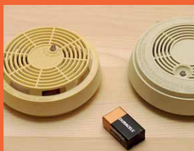
Figur 3. Batteridrevne røgalarmer i ældre bygninger, uden kobling til bygningens strømforsyning.
