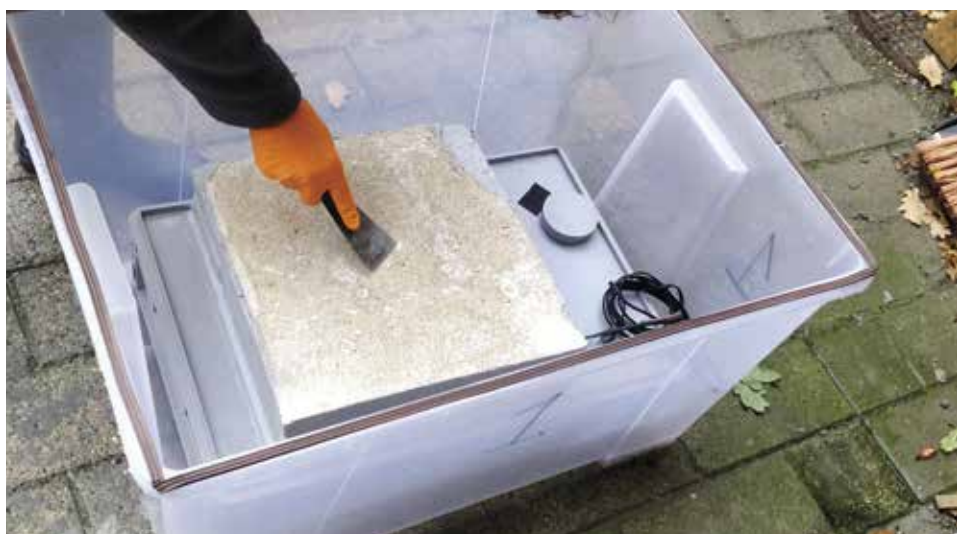
Afrensningstest 1: Her fjernes tapetrester og synlige klisterrester fra en testvæg ved håndkraft med spatel. Undersøgelsen viste, at denne metode kan efterlade massive mængder skimmelsporer.
